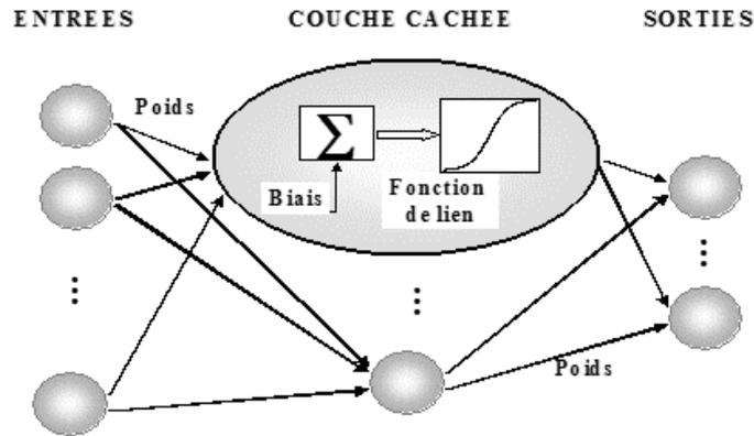
FIG. 5 – Architecture d'un réseau à une couche cachée
