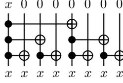
Рис. 3: Копирование значения с одного входа на дополнительные входы с логарифмической глубиной (входы схемы сверху, выходы — снизу)
