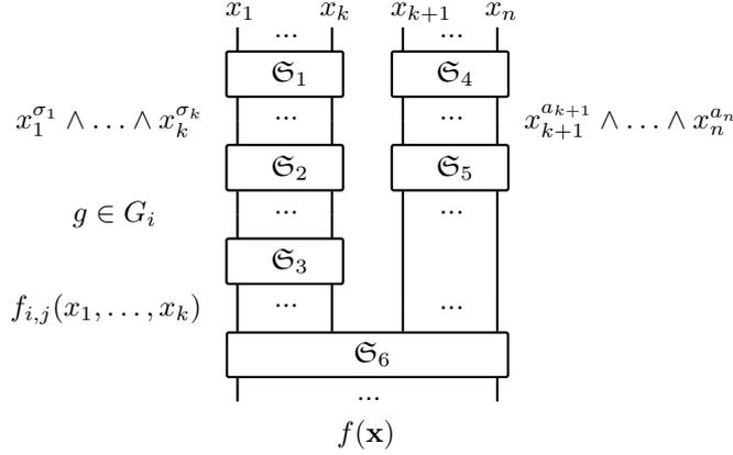
Рис. 4: Структура обратимой схемы  $\mathfrak{S}$ , реализующей отображение (8) (входы схемы сверху, выходы — снизу)
