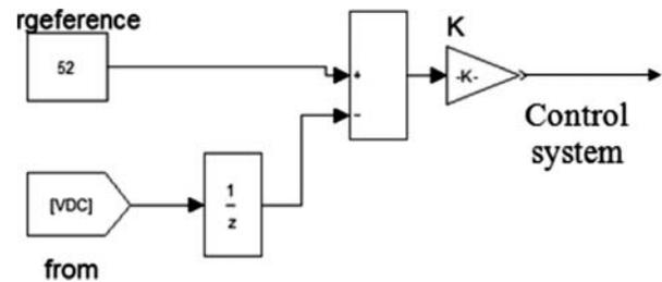
FIG. 2. VOLTAGE CONTROLLER OF DC BUS
