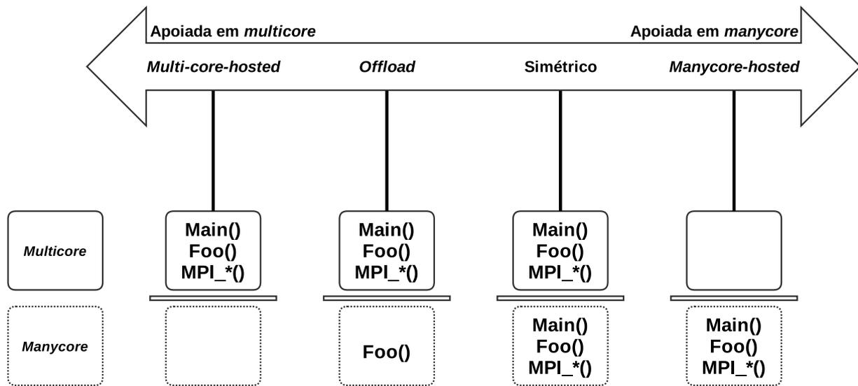
Figura 17. Abordagens de Programação Utilizando o Intel<sup>®</sup> Xeon Phi<sup>™</sup>.
