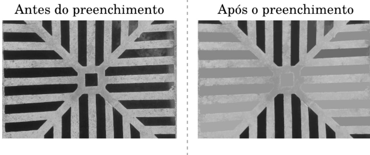
**Figura 25.** Função *Imfill* Aplicada em Tons de Cinza.
