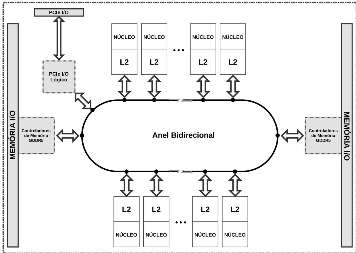
Figura 16. Diagrama de Bloco do Intel<sup>®</sup> Xeon Phi<sup>™</sup>. Adaptado de [9].
