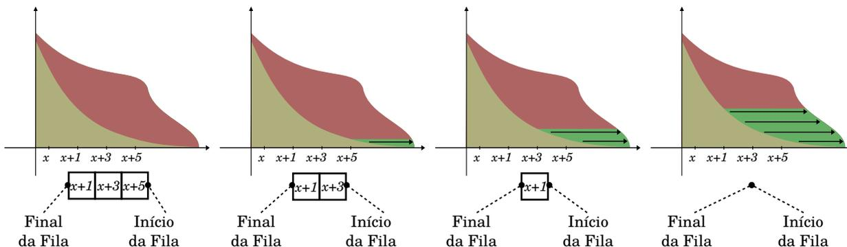
**Figura 44.** Exemplo de Propagação Utilizando Fila FIFO.
