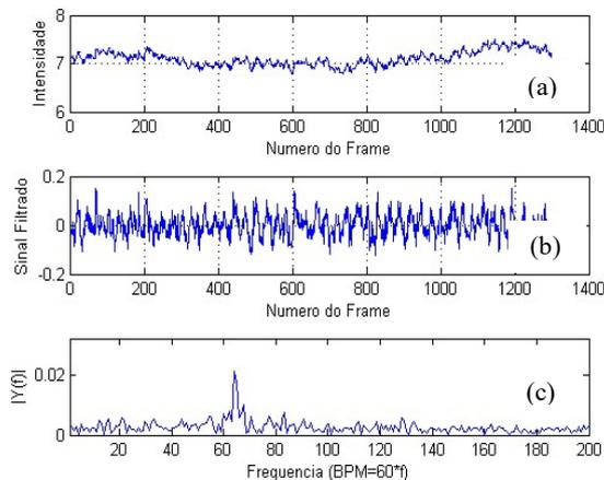
**Figura 3:** (a) Intensidade média do canal verde na ROI. (b) Sinal com variação lenta subtraída. (c) Módulo da FFT de (b).
