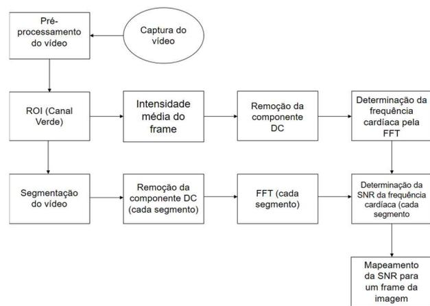
Figura 2: Fluxograma do processamento do vídeo
