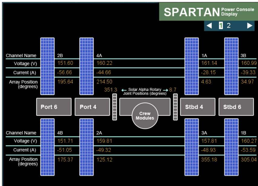
**Abbildung 6:** Die SPARTAN-Konsole dient zur Überwachung der elektrischen Versorgung der ISS (Bild: NASA, ISSLIVE).
