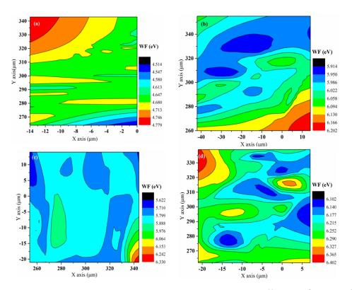
**Fig. 7.** Work function mapping of ion irradiated graphene. (a) pristine, (b)  $5 \times 10^{11}$  ions-cm<sup>-2</sup>, (c)  $1 \times 10^{12}$  ions-cm<sup>-2</sup>, (d)  $5 \times 10^{12}$  ions-cm<sup>-2</sup>.
