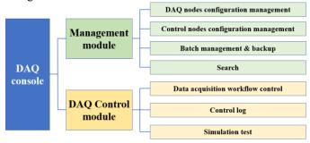
Fig. 2. DAQ console modules
