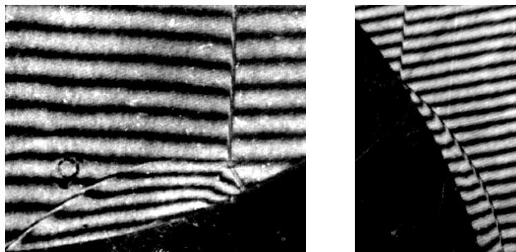
Рис.3. Отражение ударной волны от вогнутой и выпуклой цилиндрической поверхности.
