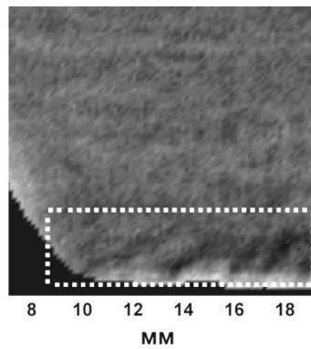
Рис.21. Кадр высокоскоростной теневой съемки течения в рабочей секции ударной трубы
