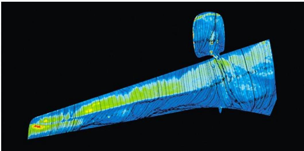
Рис.24 Метод «густого» масла. Обтекание крыла пассажирского самолета
