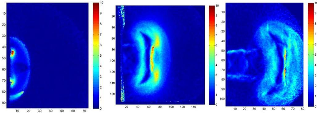
Рис.16. ТФМ изображения сверхзвукового течения при выходе ударной волны в атмосферу.
