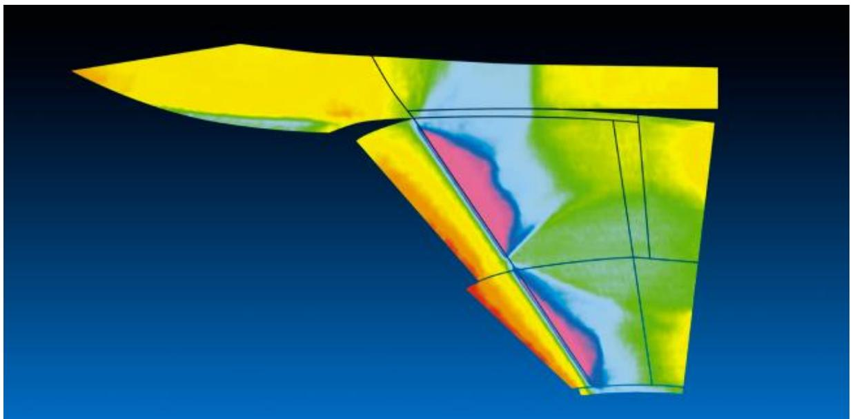
Рис.23. Распределение давления на пластине (<http://www.tsagi.ru/research/measurements/lpd2.jpg>)
