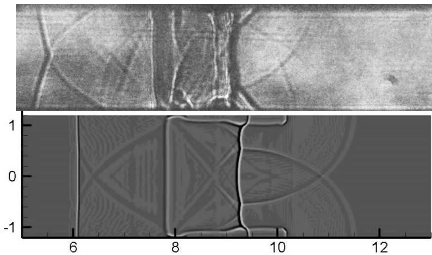
Рис.26. Сравнение расчетных и экспериментальными теневыми изображений.
