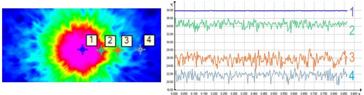
Рис. 14. Пример мгновенной термограммы и временной развертки температуры на четырех разных расстояниях ( $R$ ) от точки торможения.
