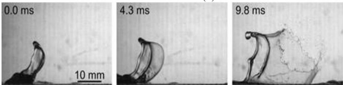
Рис.5 Формирование и разрыв структур при образовании капель.
