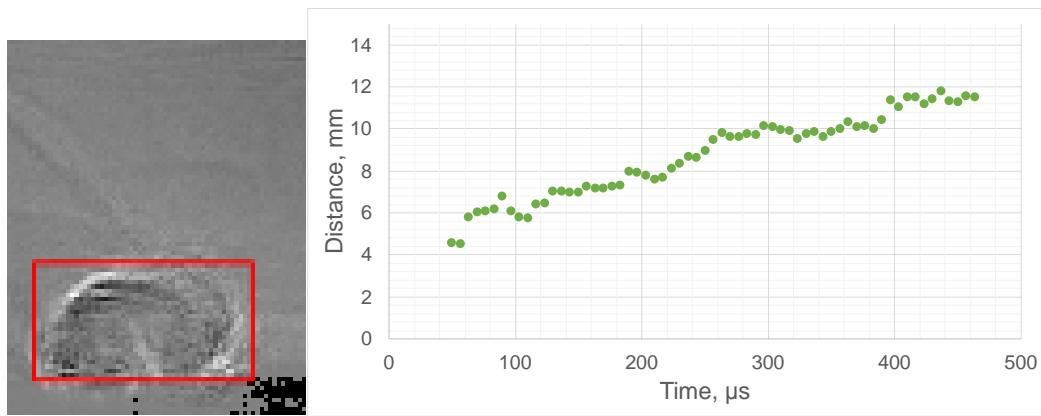
Рис. 11. Распознавание термика от импульсного разряда с помощью CNN и автоматически построенный график его роста.
