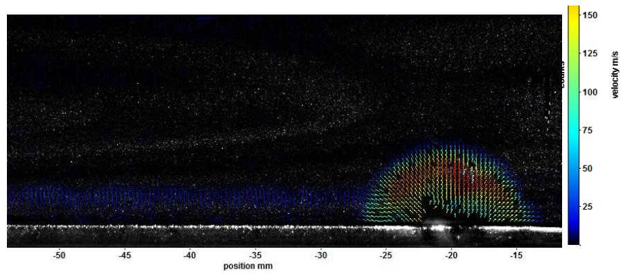
Рис.18. Поле скоростей за ударной волной, инициированной поверхностным скользящим разрядом.
