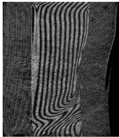
Рис.4. Сдвиговая интерферограмма.
