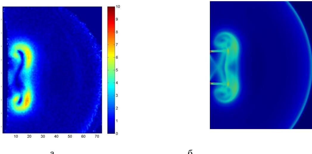
Рис.27. Сверхзвуковое двумерное течение с ударной волной и спутным потоком. Теневой фоновый метод – поле смещений (а) и численное моделирование (б).
