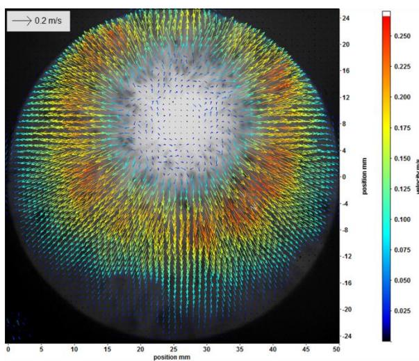
Рис.22. Метод беззасевного трассирования тепловыми точками. Поле скоростей в пограничном слое импактной затопленной струи
