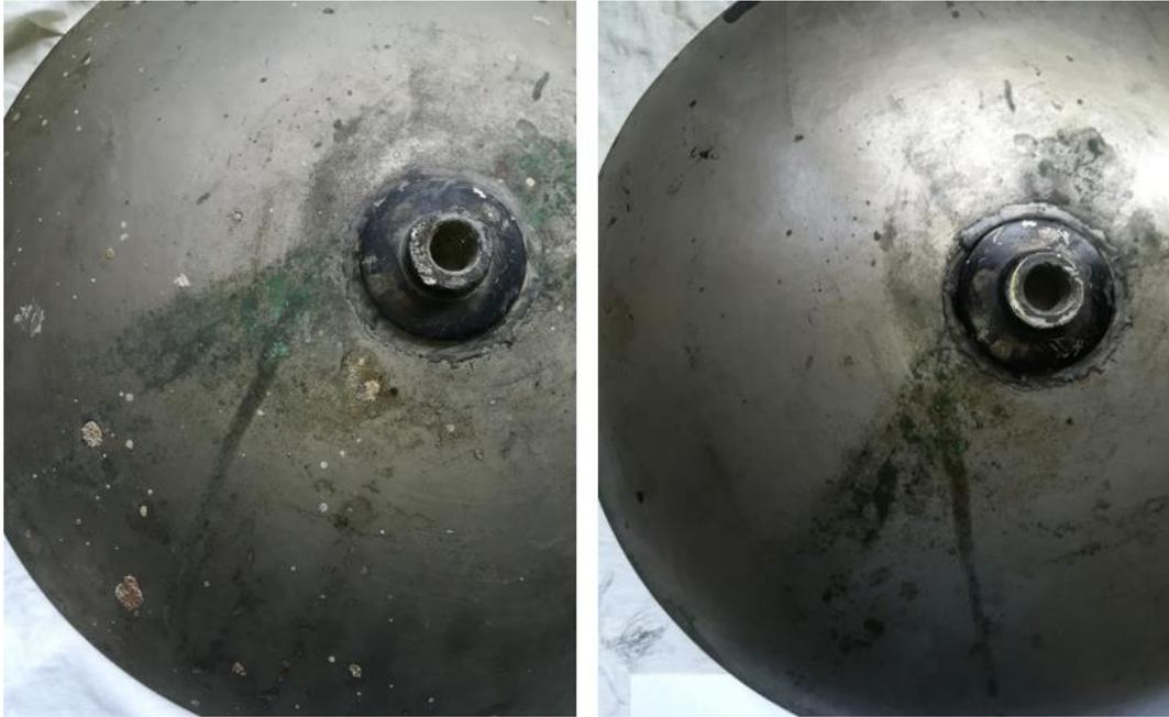
**Fig. 7.** Immagine della superficie posteriore dello specchio concavo prima (sinistra) e dopo (destra) la rimozione dei depositi superficiali.
