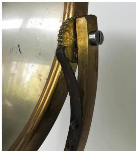
**Fig. 5.** Meccanismo a molla con ruota dentata per la regolazione dell'inclinazione dello specchio convesso e il bloccaggio dello stesso in posizione fisse e riproducibili.
