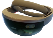
Fig. 4. An OST HMD: the Microsoft HoloLens 1.
