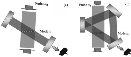
FIG. 5: Esquemas experimentales para sistemas de átomos ultrafríos en cavidades de alta reflectancia (Figuras de [20]). (a) Arreglo de cavidad de ondas estacionarias. (b) Arreglo de cavidad de ondas viajeras.
