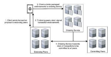
Fig. 1. Hyperledger Fabric Transaction Flow
