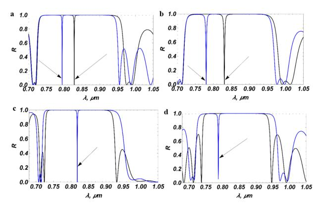
Fig. 5. Reflection spectra of 4 types of structure without a defect layer. (a,b)  $h_1=0.14 \mu m$ ,  $h_2=0.10 \mu m$ , (black)  $h_d=0.0 \mu m$ , (blue)  $h_d=0.25 \mu m$ ; (c)  $h_1=0.14 \mu m$ ,  $h_2=0.5 \times 2 \mu m$ , (black)  $h_d=0.0 \mu m$ ; (d)  $h_1=0.14 \mu m$ ,  $h_2=10 \mu m$ , (black)  $h_d=0.0 \mu m$ , (blue)  $h_d=0.10 \mu m$ ; (d)  $h_1=0.14 \mu m$ ,  $h_2=10 \mu m$ , (black)  $h_d=0.0 \mu m$ , (blue)  $h_d=0.10 \mu m$ ; N=10.
