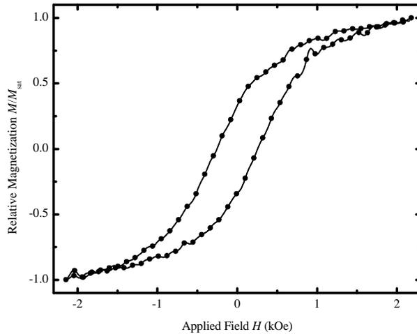
Fig. 2. Hysteresis loop of  $a\text{-Co}_{57}\text{Nb}_{43}$ .
