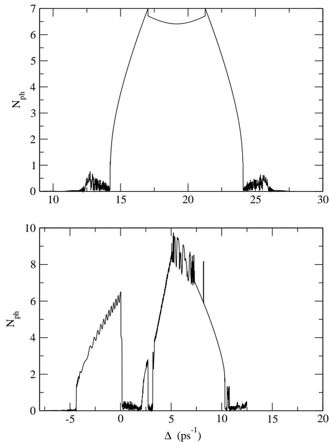
Figura 2.11: El número de fotones como función de  $\Delta$  para el punto con  $N_{states} = 2$  y parámetros  $P = 1 \text{ ps}^{-1}$ ,  $k = 0.1 \text{ ps}^{-1}$ . En el panel superior, las interacciones de Coulomb no han sido incluidas ( $\beta = 0$ ).
