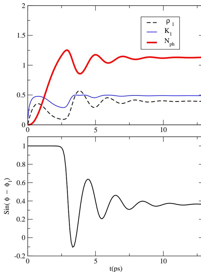
Figura 2.10: Número de fotones, ocupación y polarización del punto cuántico con un solo estado del par y parámetros  $P = 1 \text{ ps}^{-1}$ ,  $k = 0.5 \text{ ps}^{-1}$ . El parámetro  $\Delta$  es  $4.5 \text{ ps}^{-1}$  (resonancia máxima).
